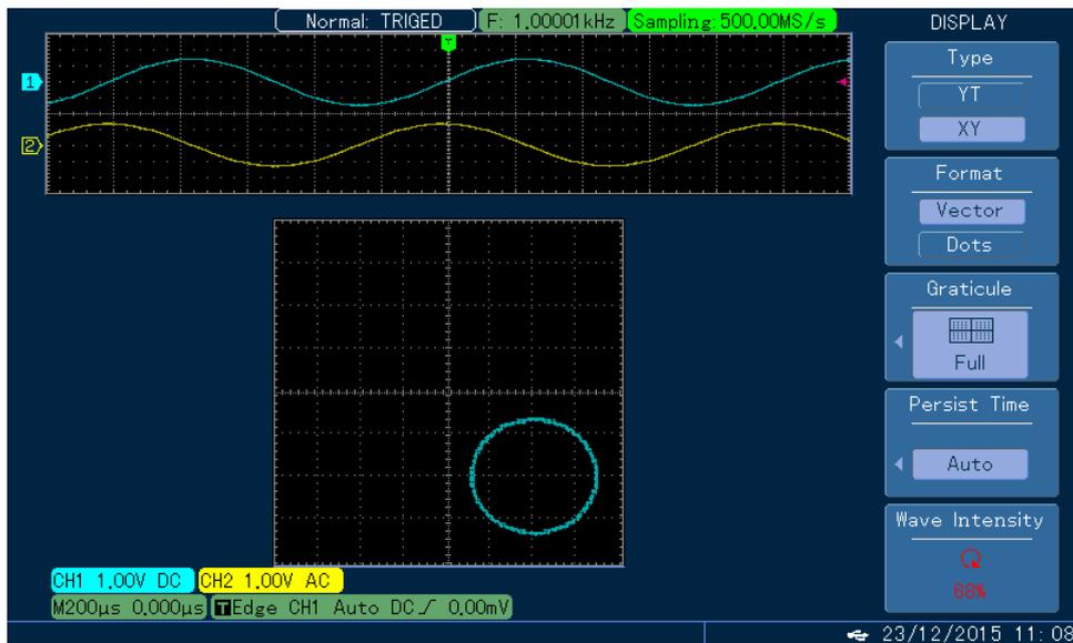
Fig. 2-32 X-Y 모드에서의 파형 화면 (위상차)
