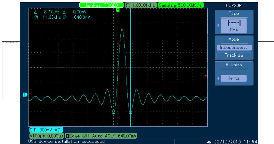
Fig. 3-6 커서를 이용한 신호 주파수 측정
