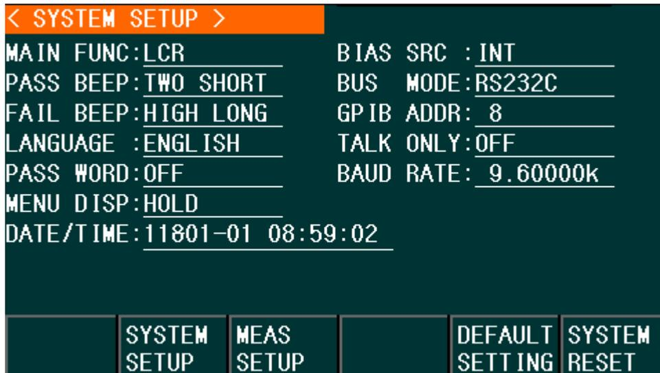
이 페이지에는 계측기 주 기능, 신호음, PASS 신호음, FAIL 신호음, 언어, PASS WORD, BUS 모드, GPIB 주소, TALK 전용, 바이어스 SRC, 전송 속도, 메뉴 표시 및 데이터 / 전송, 시간과 같은 대부분의 시스템 설정 항목이 표시됩니다.
