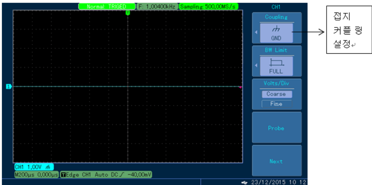
Fig. 2-4 AC 및 DC 구성요소가 신호에서 동시 차단된 표시 화면
